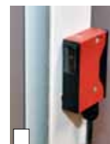
Lichtschranke unten zur Durchfahrtsicherung
